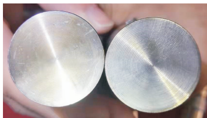
图 7 同一粗糙度不同表面波纹形貌对比
